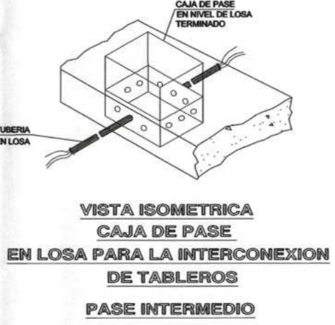
VISTA ISOMETRICA CAJA DE PASE EN LOSA PARA LA INTERCONEXION DE TABLEROS DE TABLEROS PASE INTERMEDIO
